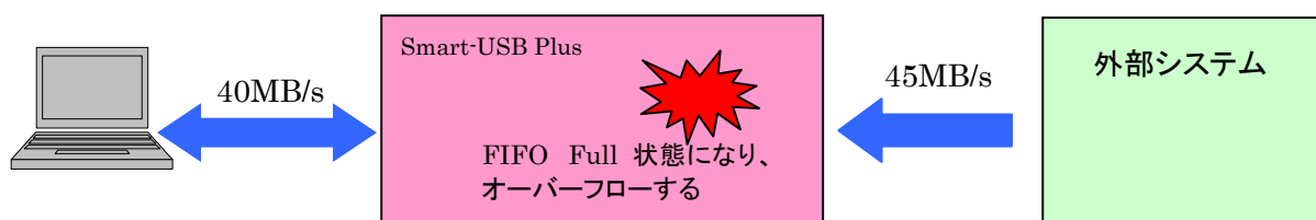
<図 12. iSRAMFIFO モジュールを適用してデータ収集する場合のデータ転送レート>
